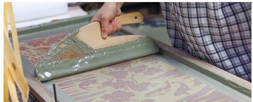
將固定於木框上的型紙放在布料上，使用刮刀在沒有要染色的部分塗抹防染糊。將布料摺疊成風琴狀，並反覆進行置糊作業。
