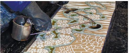
用水壺注入染料，未覆蓋防染糊的部分將會被染色。透過從布料下方吸取染料，使染料徹底染到底部。透過同時倒入不同顏色，可以創造美麗的漸層(暈染)。
