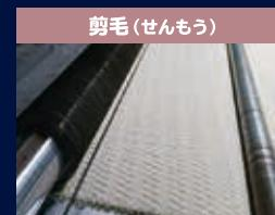
山状のうねになっているパイル糸の中央を専用の道具を使いカットし、起毛させる。剪毛は別珍の呼び方で、コール天ではカッティングと呼ぶ。
