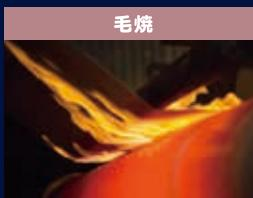
剪毛やカッティングした後、無駄な毛やパイル糸の長さをそろえるため、800度以上に熱したローラーの上に布を接触させ、表面を焼く。
